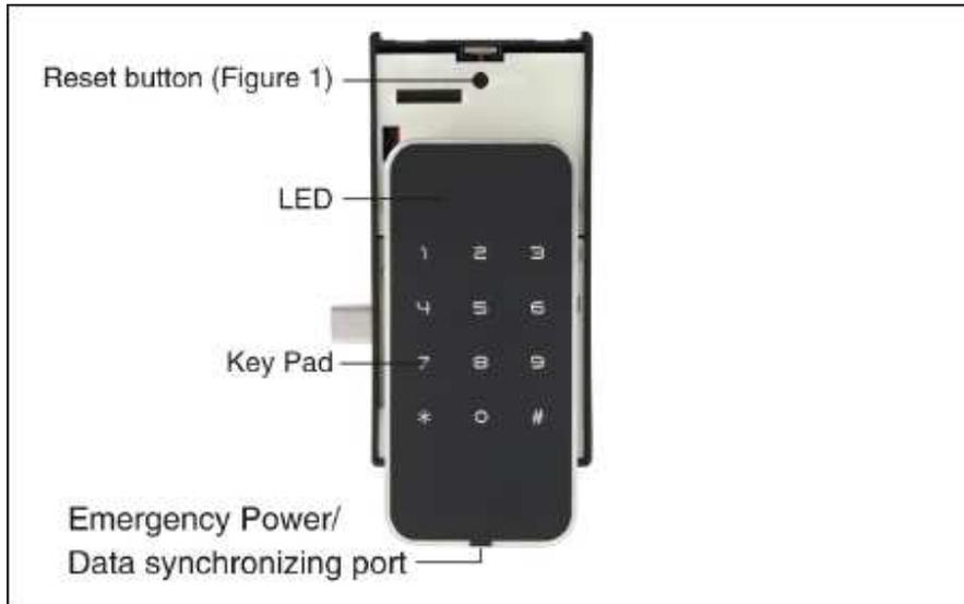
**Procedimento A - Resetar a fechadura:** Coloque as pilhas, e aperte e segure o botão reset conforme figura 1, um sinal luminoso branco será emitido e mais 3 beeps sonoros. Após reset, o código de proprietário voltará a ser 123456.
